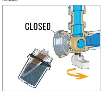
La particolare conformazione della valvola di intercettazione consente di effettuare la pulizia degli elementi interni scaricando la sola acqua contenuta nel filtro.
